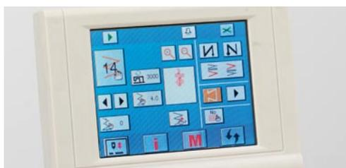
Šířka a typ stehu se nastavuje pomocí klávesnice, na které jsou dostupné i další funkce jako odstříh, nastavení polohy jehly, patky apod.
